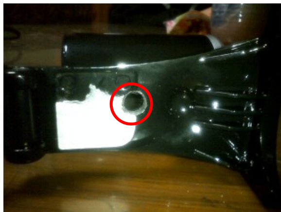
(台座部分に穿孔したところ。図の赤丸部分が穿孔を行った部分)
